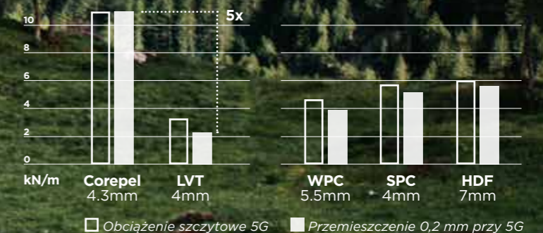
Test wytrzymałości na rozciąganie: 5x większa siła zamków
